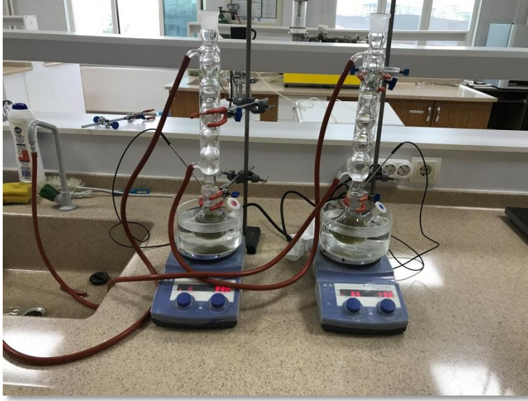
Resim 3.3 Biyodizel sentez deney düzeneđi.
