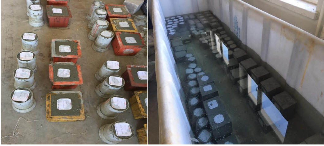
Resim 3.1 Kalıplarda bekletilen ve kür yapılan numuneler.
