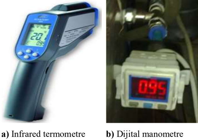
Resim 3.7 İnfrared termometre ve dijital manometre (Aksoy et al. 2016).
