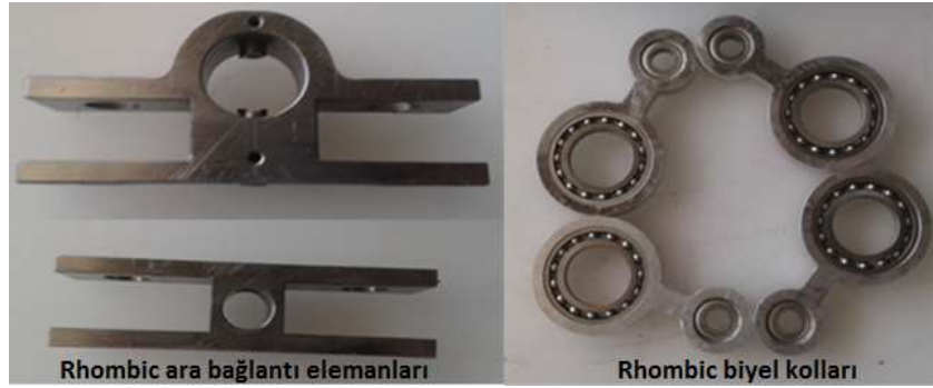
Resim 3.1 Rhombic biyel kolları ve ara bağlantı parçaları (Aksoy et al. 2016).
