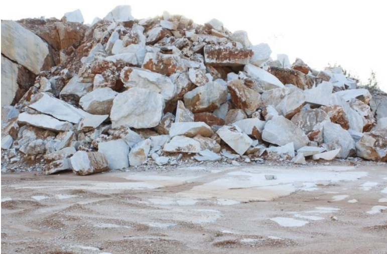
Şekil 2. Ocakta oluşan pasa.
