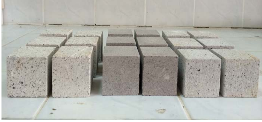
Şekil 2. Deneylerde kullanılan yapı taşı örneklerinin testlere hazır hale getirildikten sonraki görünümü (The view of the building stone samples used in the experiments).
