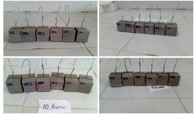
Şekil 10. Sodyum klorür çözeltisinde 1, 5, 10, ve 15. periyotlardaki andezit örneklerinin görünümü.
