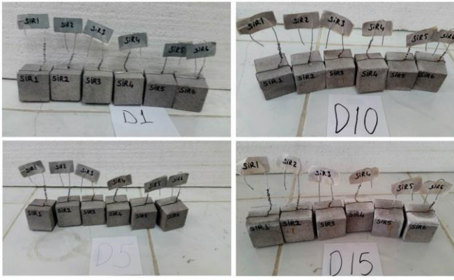
Şekil 8. Sodyum sülfat dekahidrat çözeltisinde 1, 5, 10, ve 15. periyotlardaki andezit örneklerinin görünümü.
