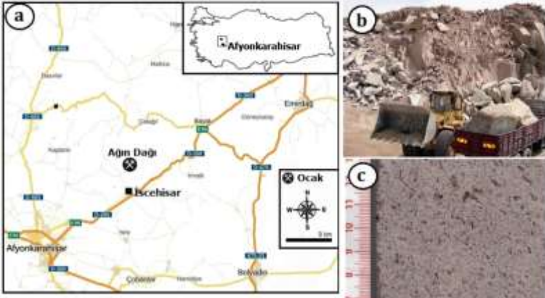
Şekil 2. Deneylerde kullanılan andezit örneklerinin (a) ocağın lokasyon haritası (b) ocağın görünümü, (c) yüzey görünümü.
