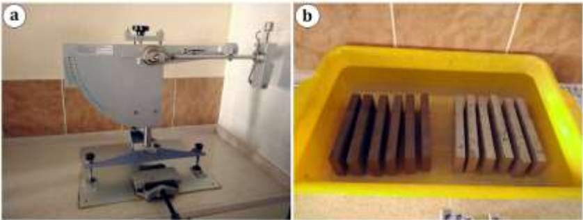
Şekil 3. Deneylerde kullanılan Pandül cihazı (a) ve andezit örnekleri (b).
