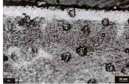
Şekil 1. EKabor®-II tozuyla 900 °C'de 2 saat borlanmış olan Küresel Grafitli Dökme Demirin optik mikro yapısı, a) Tozun ilk kullanımı b) Tozun 2. kullanımı c) Tozun 3. kullanımı.
