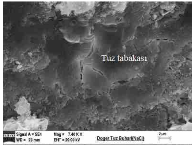
Şekil 10. Tuz buharıyla yıpranmaya karşı direncin tayini deneyi sonrası Döğer tüfü yüzeyinde oluşan tuz-halit (NaCl) tabakasının görünümü
