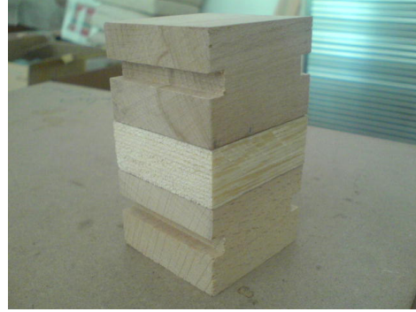
Şekil 4.2, Resim 4.3. Liflere Dik Çekme (Yapışma Direnci) Deneyi Numune Parçası
