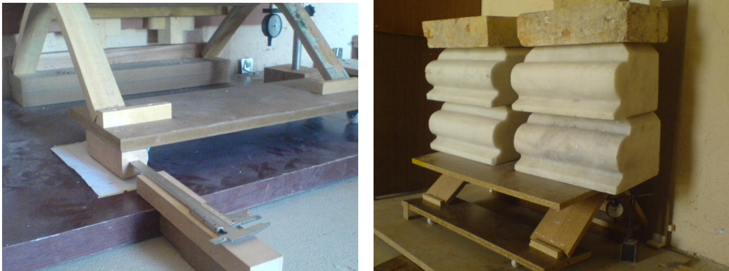
Resim 4.9-10. 50 ve 150 mm'lik Deney Örneklerine Uygulanan Diyagonal Çekme Deneyi
