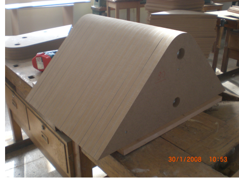
Şekil 3.1, Resim 3.1. Deney Örneklerinin Preslenmesinde Kullanılan Kalıp Örneği
