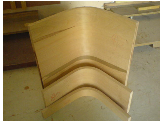
Resim 3.2-3. Boyutlandırılmamış ve Boyutlandırılmış Farklı Genişliklerdeki Deney Örnekleri
