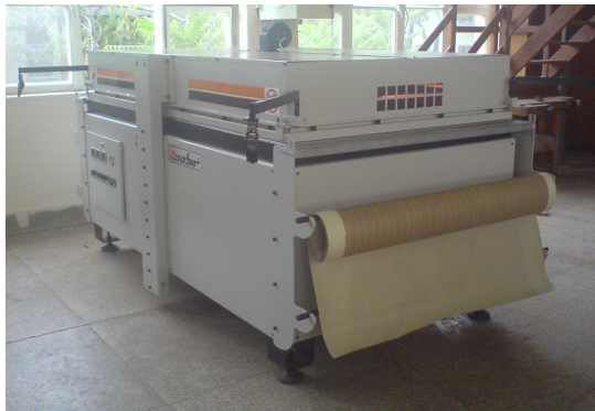
Resim 2.1-2. Vakumlu Membran Pres Makinesi Ve Preste Kullanılan Kalıp Örneği
