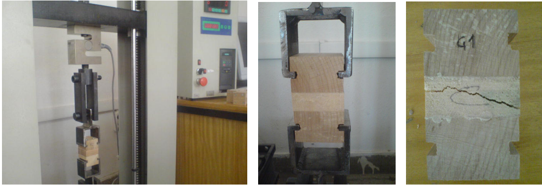
Resim 4.4-6. Üniversal Test Cihazı ve Liflere Dik Çekme (İç yapışma) deney örneği
