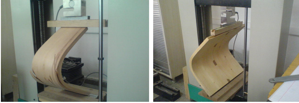
Resim 4.7-8. Diyagonal Basınç Deneyi
