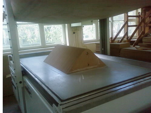
Resim 2.1-2. Vakumlu Membran Pres Makinesi Ve Preste Kullanılan Kalıp Örneği
