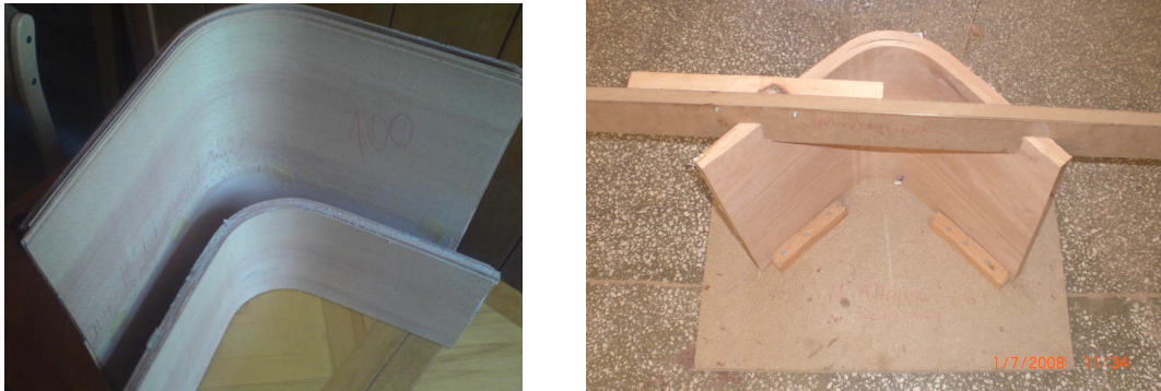
Resim 5.7-8. Deney Örnekleri ve Deformasyonu Engellemek İçin Kullanılan Kalıp
