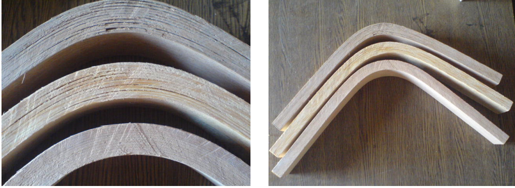
Resim 5.5-6. Kusurlu Deney Parçası Örnekleri
