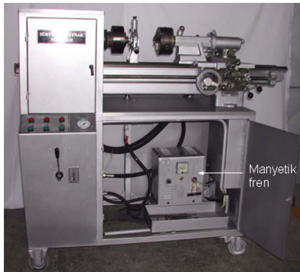
Şekil 2 İmalatı gerçekleştirilen sürekli tahrikli sürtünme kaynak makinesinin hidrolik ve elektrik donanımı
