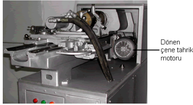
Şekil 5. İmalatı gerçekleştirilen sürekli tahrikli sürtünme kaynak makinesi detayları.
