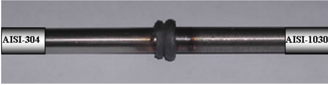
Şekil 11. Sürtünme kaynağıyla birleştirilen AISI-1030 ile AISI-304 malzemenin kaynağı.
