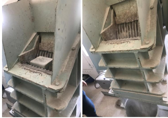
Resim 3.1 Çeneli kırıcı ile agrega haline getirilen atık beton numuneleri.
