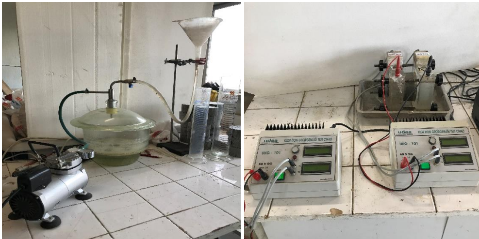
Resim 3.9 Vakum işlemi ve hızlı klorür geçirirliği deney düzeneği.
