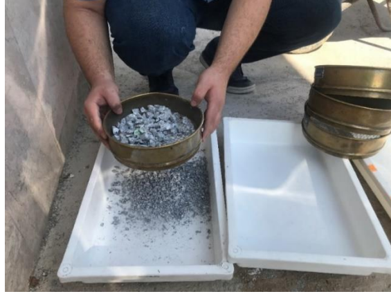
Resim 3.2 Geri dönüştürülmüş beton agregalarının eleme işlemi.
