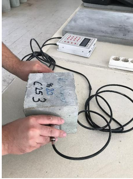
Resim 3.6 Ultrases geiř süresi deneyinin yapıřı.
