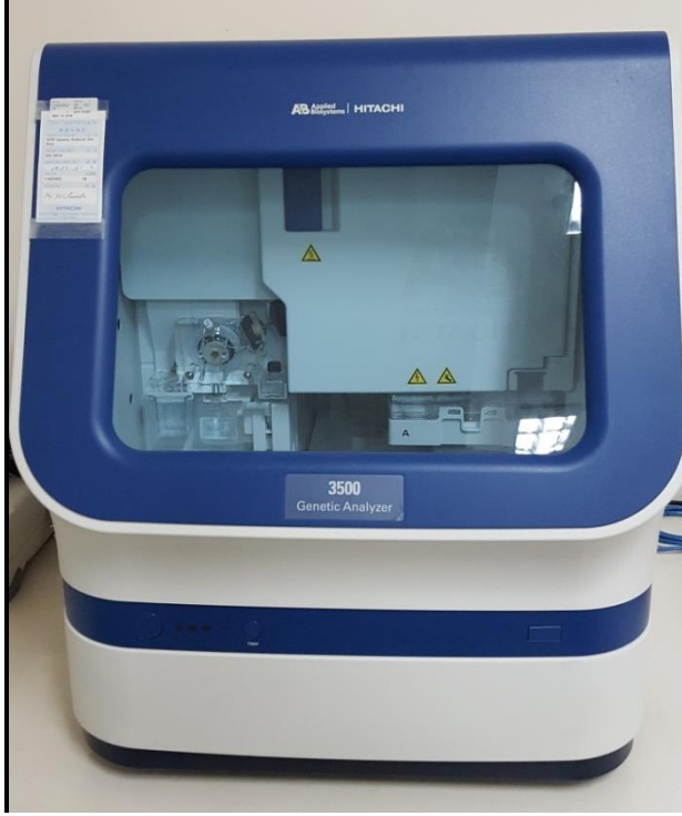
Şekil 2.4. DNA Dizi Analiz Cihazı
