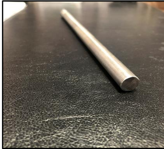
Şekil 20. Yanık yarası oluşturulmasında kullanılan silindirik metal çubuk (1 cm çapında)
