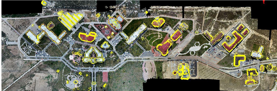
Şekil 4.18 QuickTerrain yazılımında vektör yapılması.
