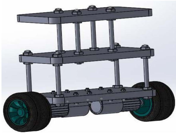
Şekil 2.6 3 boyutlu denge robotunun tasarımı.
