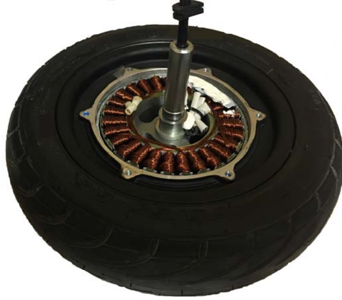
Şekil 3.17 Tekerlek içerisine gömülü FDAM.
