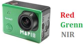
Şekil 4.6 Mapir Survey 3 Kamera (İnt. Kyn.5).
