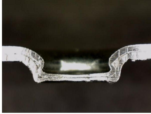
Resim 4. 3 Erdemir 1312 0.5 mm-0.5 mm birleştirilmiş malzeme kesiti
