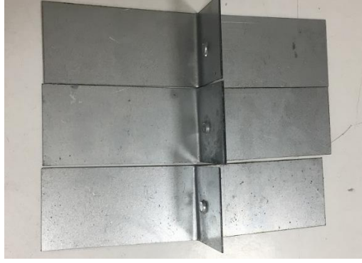
Resim 3.5 Soyma deneyi için birleştirilmiş malzemeler
