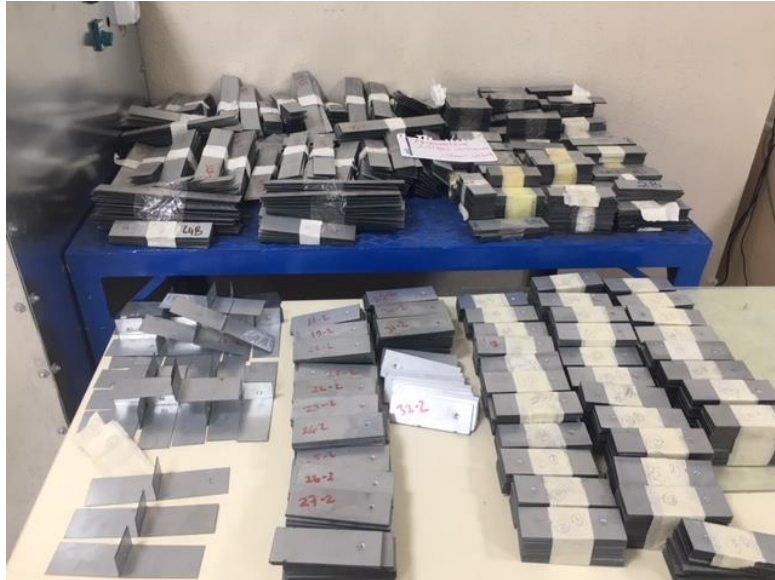
Resim 3.4 Kesme deneyi için birleştirilmiş malzemeler
