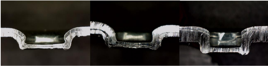
Resim 5. 1 Form punta ile birleřtirilmiř malzeme kesiti
