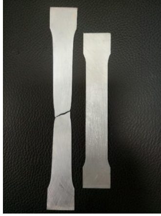
Resim 4.1 Çekme deneyi sonucunda kopan malzemeler
