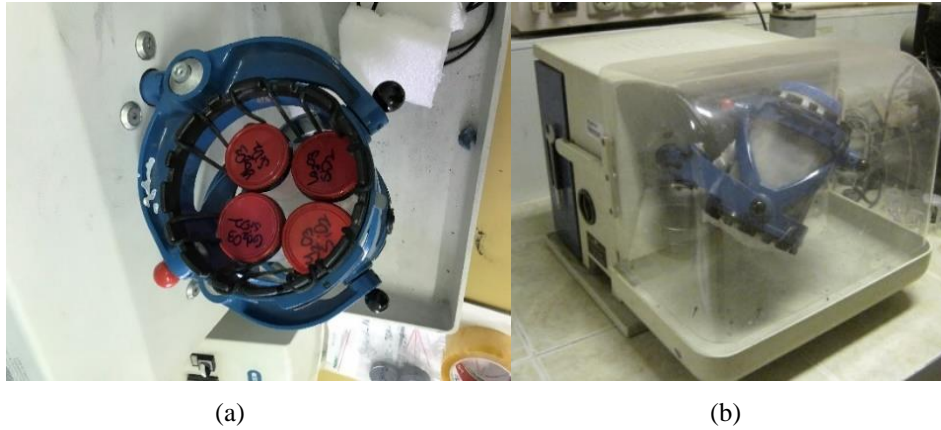
Resim 3.2 (a) Numunelerin Turbula marka Kuru karıştırıcıya koyulması ve (b) Turbula marka Kuru karıştırıcı.
