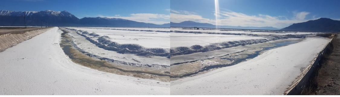
Resim 2.2 Çöken kristal sodyum sülfat (mirabillit) tabakaları.
