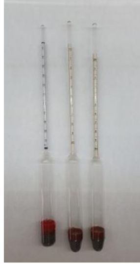
Resim 3.4 Bomemetre ve bome ölçüm görseli.
