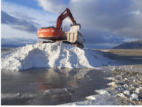
Resim 2.4 Mirabilite yığınlarının havuz içinden tesise sevki çalışmalarından bir görsel.
