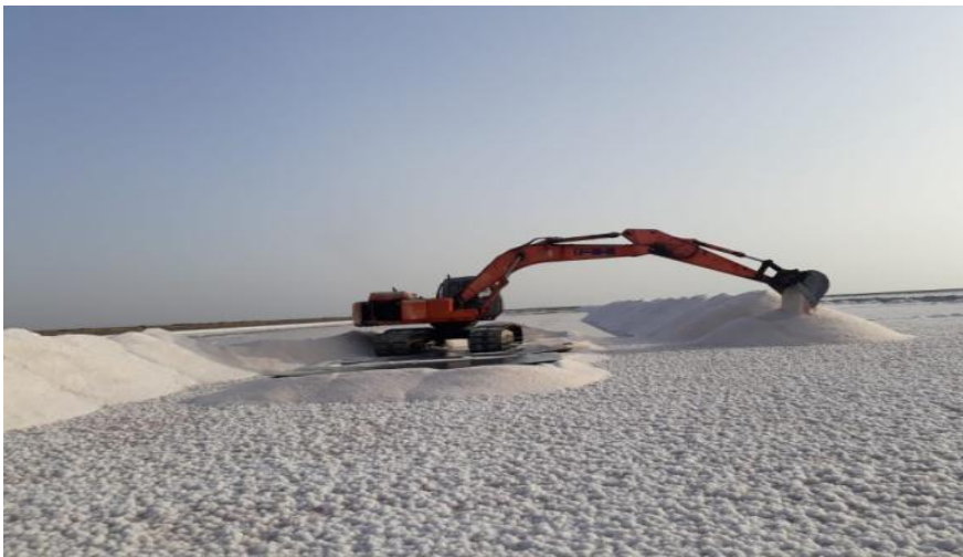
Resim 2.7 Paletli ekskavatör ile NaCl üretimi.
