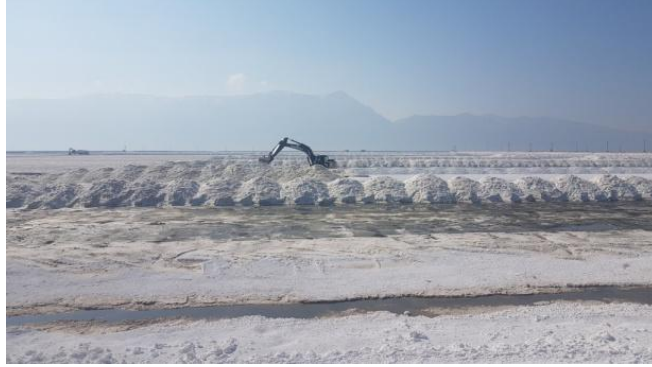
Resim 2.3 Mirabillitin iş makinaları ile toplanması.
