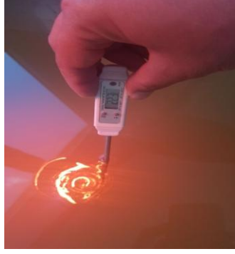
Resim 3.3 Buharlaştırma tavası yüzey sıcaklık kontrolü.
