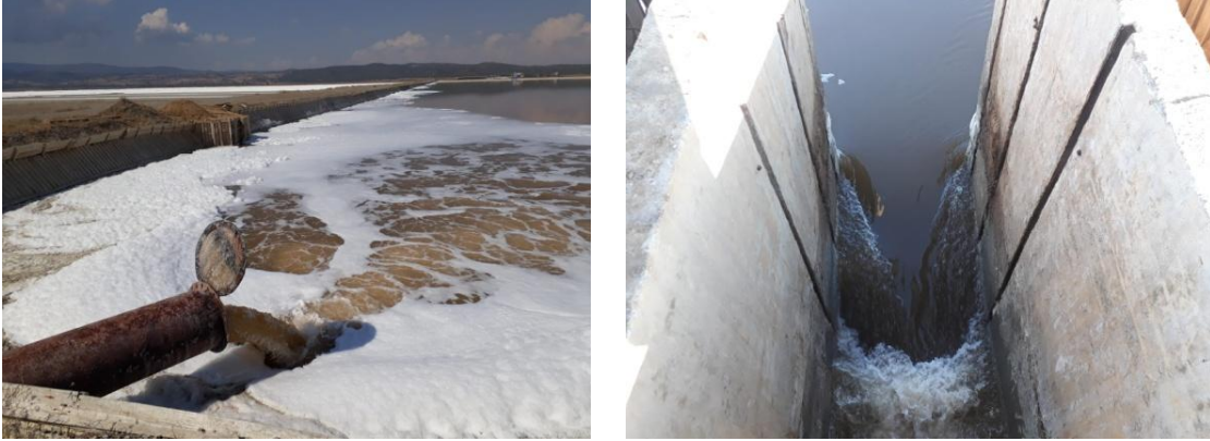
Resim 2.1 Üretim havuzuna ÖBH'dan yüksek Bome'li su alınması (a) ve soğuk hava koşullarında kristalizasyon sonrası üst tuzlu suyun boşaltılması (b).
