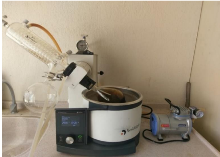
Resim 3.15 Evaporatör ile diklorometanı uzaklaştırma işlemi.
