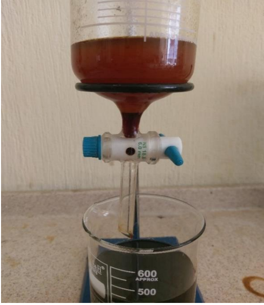
Resim 3.13 Yakıttan suyun uzaklaştırılması.
