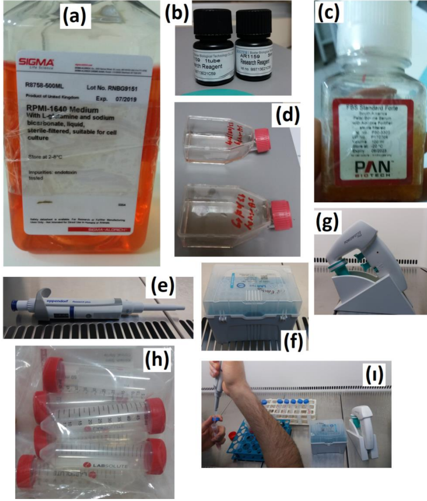
Şekil 3.8 Biyoyoumluluk testlerinde kullanılan araç ve gereçler, (a) besiyeri, (b) wst kit sıvısı, (c) fetal bovin serum, (d) T flask, (e) pipet, (f) pipet ucu, (g) pipet pompası, (h) falkon tüp, (i) falkon tüplere besiyeri doldurulma anı.
