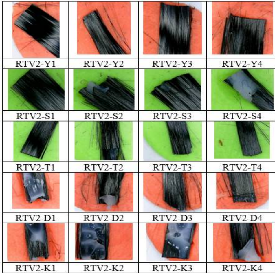
Şekil 4.1 Fiber çekme testi sonucu fiber uçlarında kalan fiberlerin optik mikroskop yardımı ile elde edilen görüntüleri.
