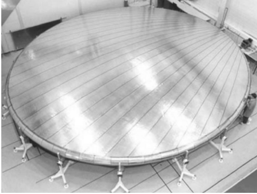
Şekil 2.9 Conraves Uzay Birimi’nde geliştirilen şişirme-rijitleme yöntemi ile kapanıp açılabilen reflektör anten (Cassapakis and Thomas 1995).
