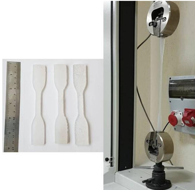
Şekil 3.8 Silikon bileşenlere çekme testi uygulanması: a) standarda göre üretilen numuneler, b) test düzeneği.
