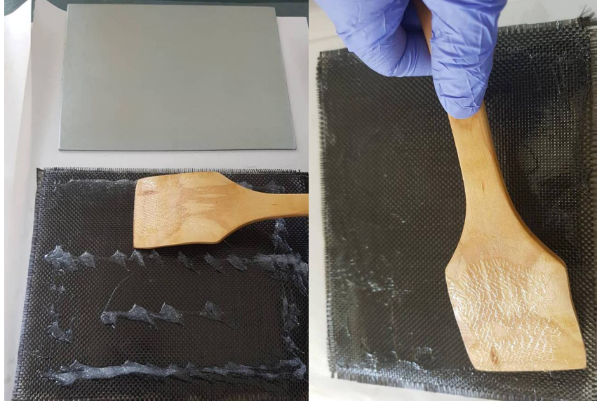
Şekil 3.9 Kompozit numunelerin hazırlanmasında silikonun uygulama aşaması.
