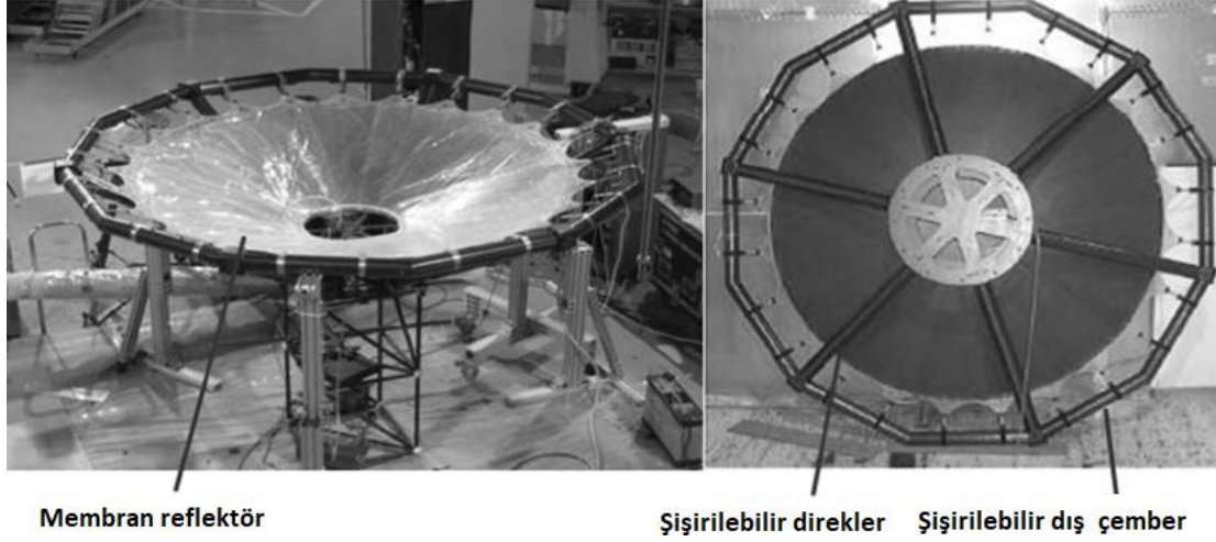
Şekil 2.11 Şekil hafızalı polimer ve şişirilebilen iskelet sistemi yardımıyla açılıp kapatılabilen reflektör membranı (Gaspar et al. 2007).
