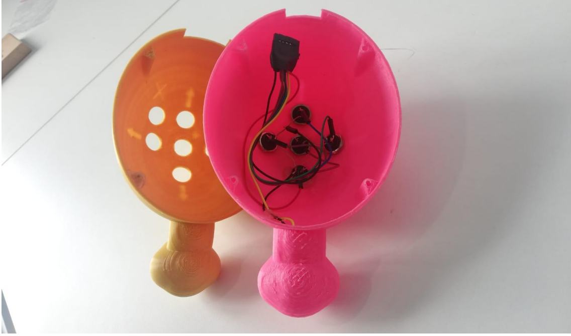
Resim 4.11 Üst gövdenin montaj öncesi ve sonraki görüntüsüne ilişkin görsel.
