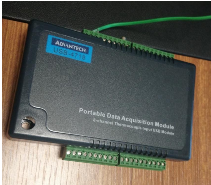
Şekil 3.4 Sıcaklık ölçümünde kullanılan 8 kanallı veri alma modülü.
