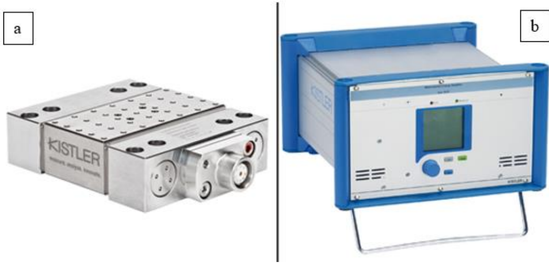
Şekil 3.7 a) Kistler 9119AA1 dinamometre, b) Kistler 5070 çok kanallı amplifikatör.
