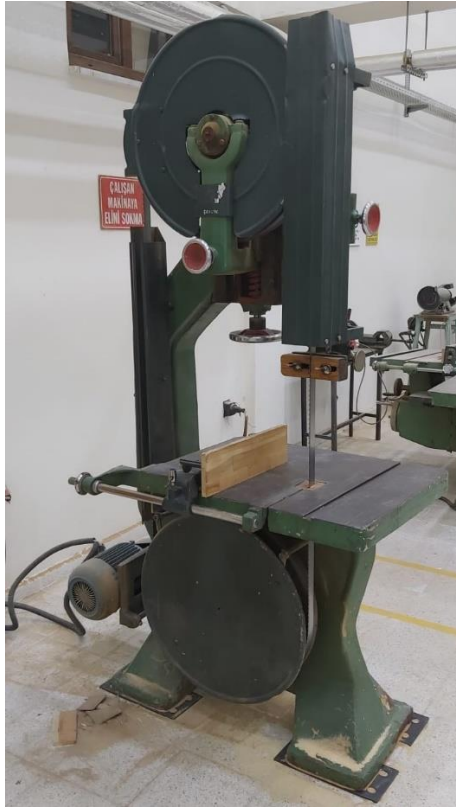
Şekil 3.13 Kemiklerin parçalanarak deney numunelerinin hazırlandığı dikey şerit testere.
