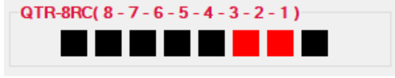
Şekil 4.35 Kızılötesi sensör position değerine göre label kontrolleri görünümü.
