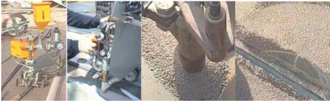
Resim 2.5 Kaynak bölgesine dökülen toz malzeme (Tama 2009).
