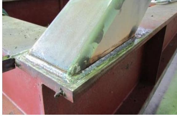
Resim 2.11 Açılı köşe kaynak uygulaması.
