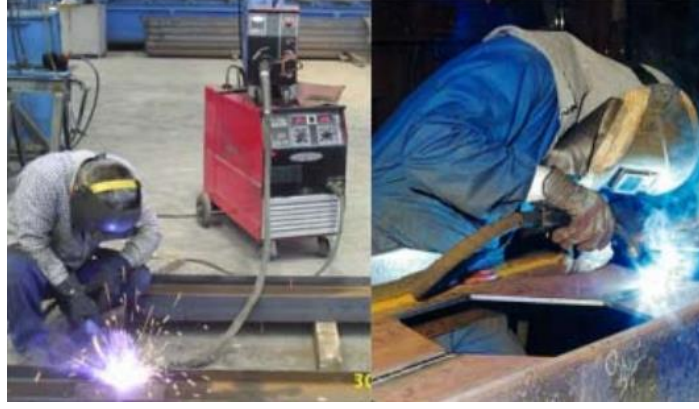
Resim 2.7 MIG kaynak uygulaması (Tama 2009).
