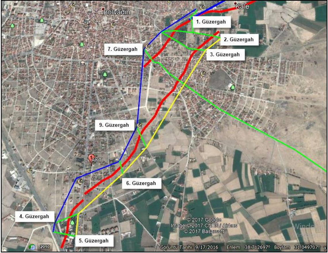
Şekil 4.4 Nivelman güzergâhlarının Google earth uydu görüntüsü üzerindeki lokasyonları; kırmızı hatlar yüzey deformasyonlarını, yeşil hatlar nivelman güzergâhlarını, sarı ve mavi hatlar bağlantı nivelmanını göstermektedir (Bozkuş 2019).
