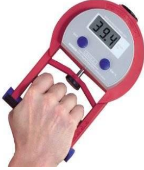
Resim 2.7. Takei el kavrama kuvvet dinamometresi
