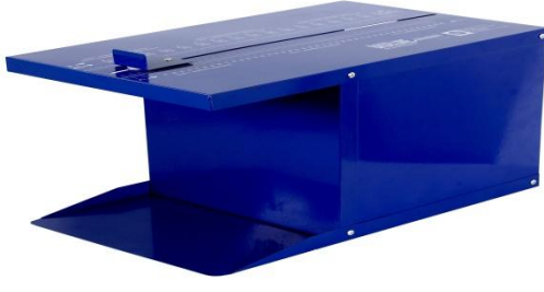
Resim 2.3. Esneklik ölçüm aleti (Baseline Sit And Reach)
