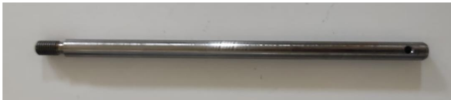
Resim 4.7 Yer değiştirme pistonu rodu (Erdem 2019).
