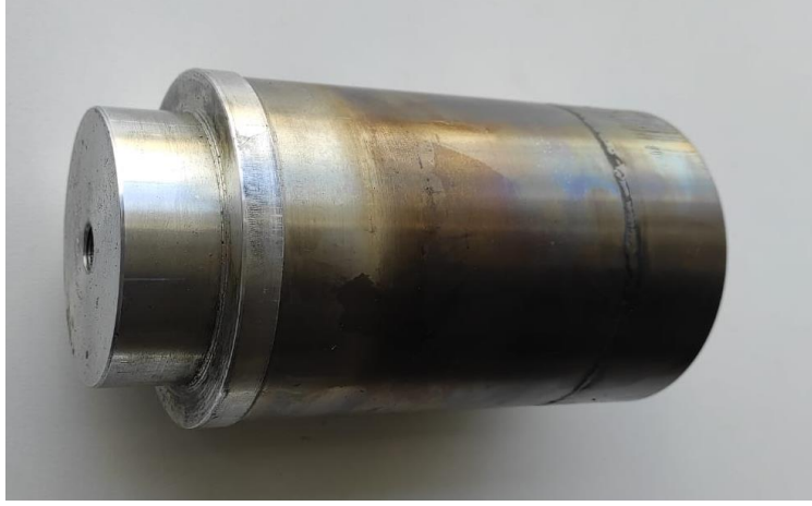
Resim 4.1 Yer deęiřtirme pistonu (Erdem 2019).
