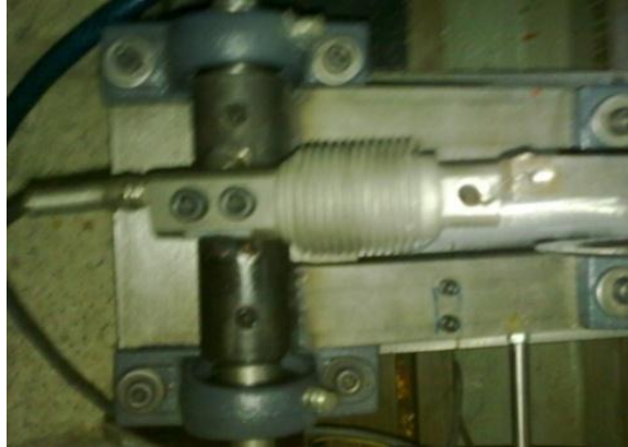
Resim 4.12 Yük hücresi (Load-cell) (Erdem 2019).
