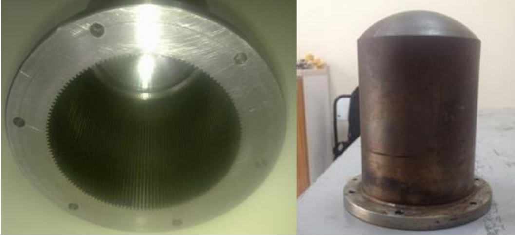
Resim 4.2 Borusuz yer deęiřtirme silindiri (Erdem 2019).
