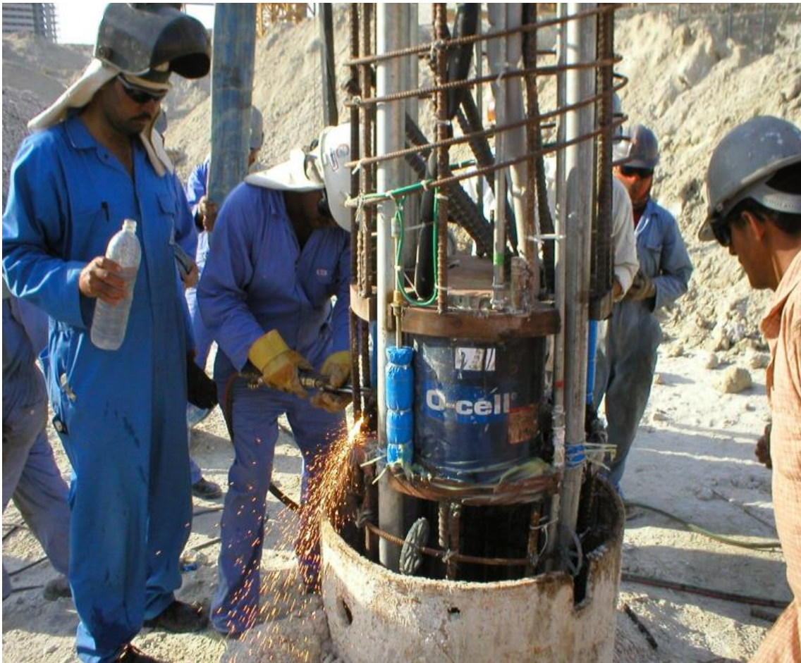
Resim 3.4 Osterberg deney yapılışı.
