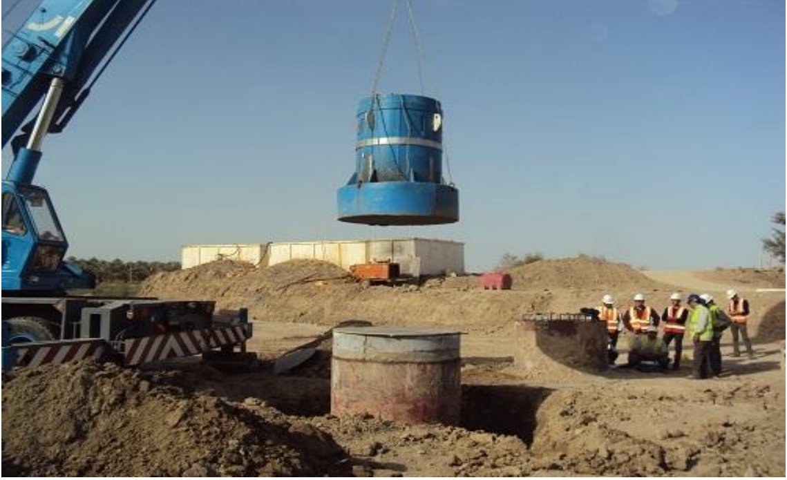
Resim 3.7 Dinamik kazık yükleme deney yapılışı.
