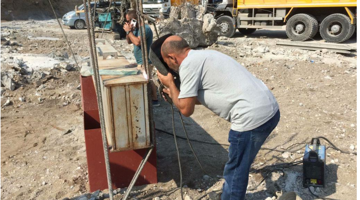
Resim 3.13 Reaksiyon kiriş örneği.
