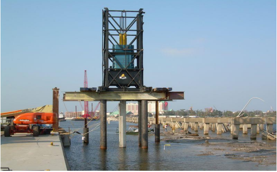
Resim 3.5 Statnamic deney yapılışı.
