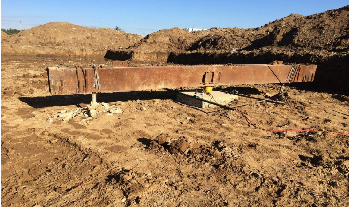
Resim 3.1 Eksenel basınç deney düzeneği.
