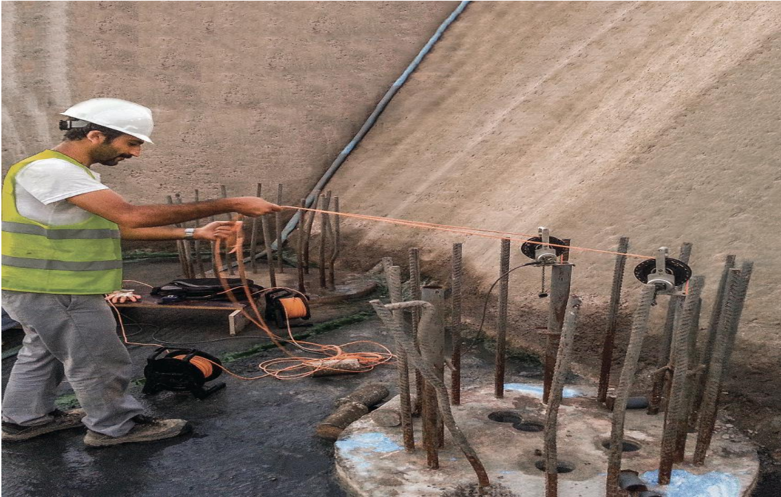
Resim 3.10 Çapraz sonik süreklilik testi.
