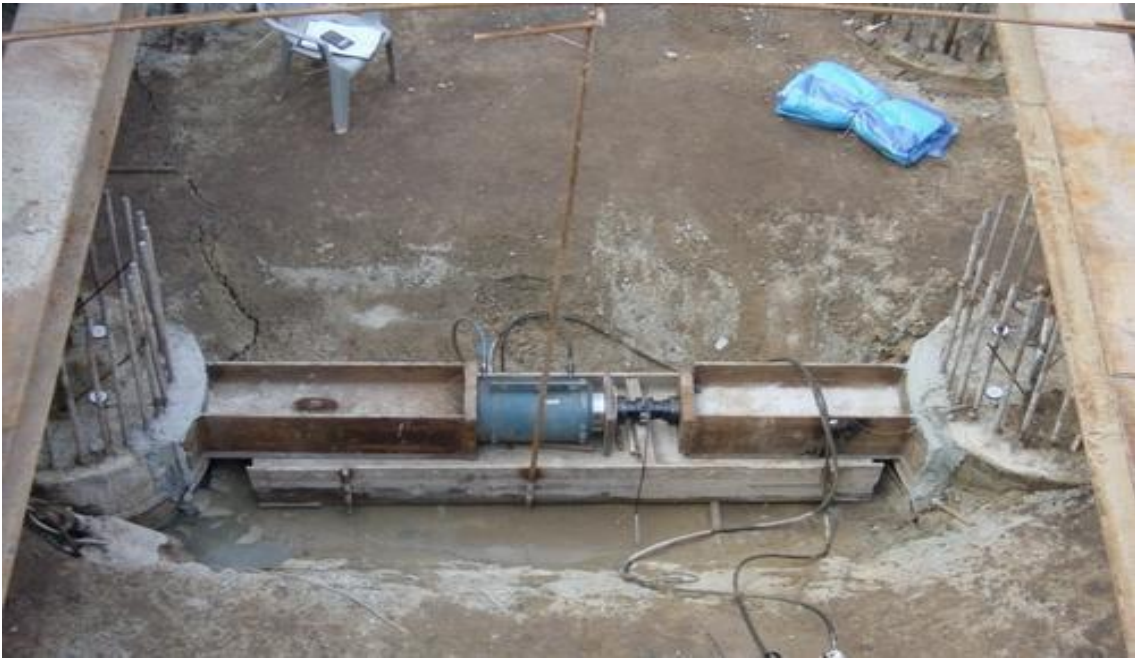
Resim 3.3 Yanal yükleme deney düzeneği.
