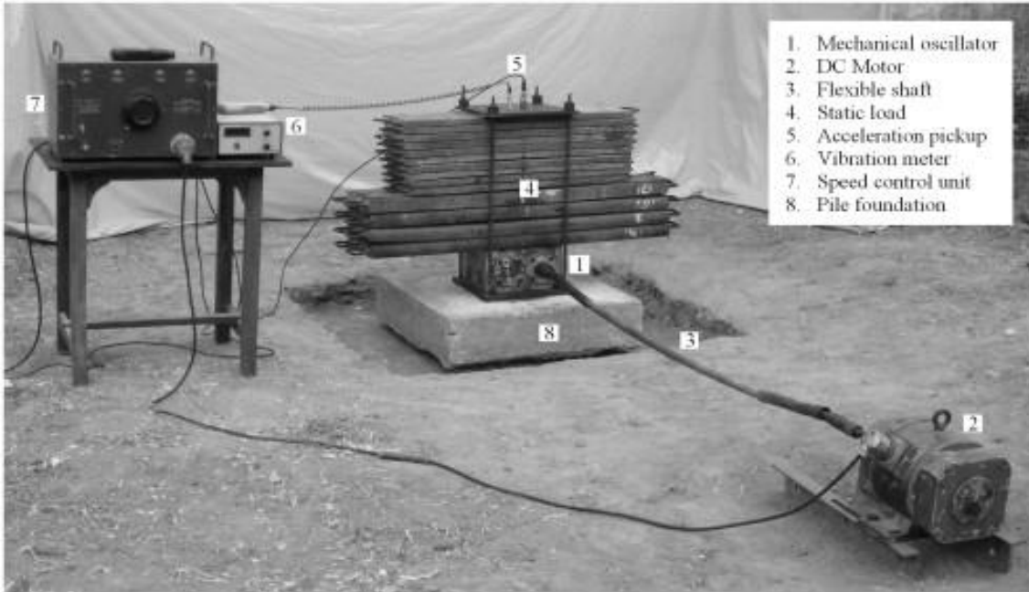
Resim 3.8 Vibrasyon deney yapılışı.
