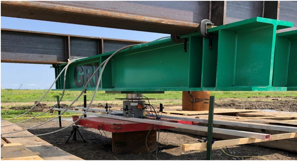
Resim 3.2 Eksenel çekme deney düzeneği.
