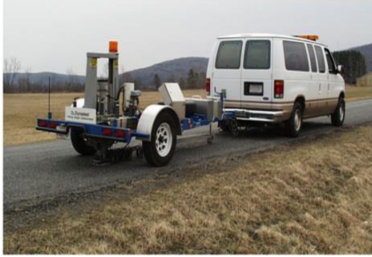
Resim 2.2 Dynatest model düşen ağırlıklı deflektometre cihazı (İnt.Kyn.4)
