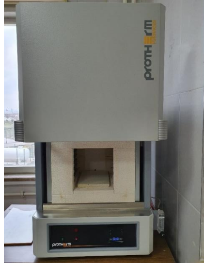
Şekil 3.7 Kalsinasyon için kullanılan yüksek sıcaklık fırını.
