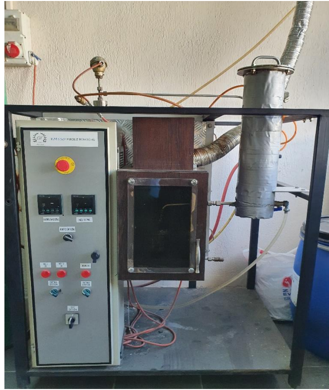
Şekil 3.1 Deneyleerde kullanılan yavaş piroliz cihazı.
