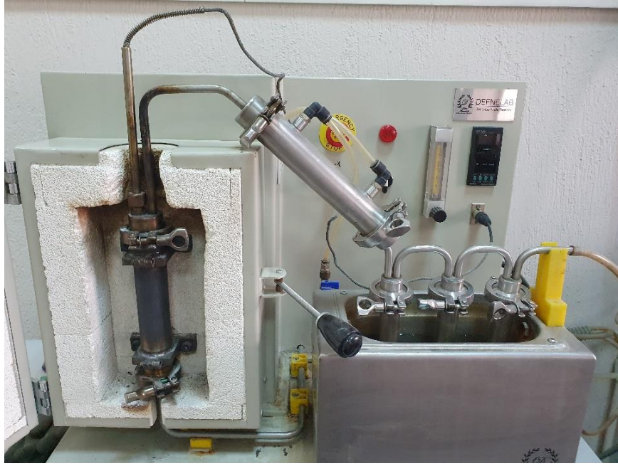
Şekil 3.2 Deneylede kullanılan hızlı piroliz cihazı.
