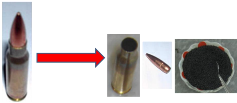
Resim 3.11 Kovan, çekirdek ve barutun mermiden ayrılması.
