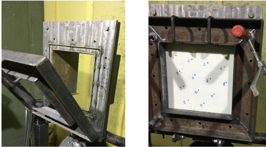
Resim 4.2 Test malzemesinin sabitlenmesi.
