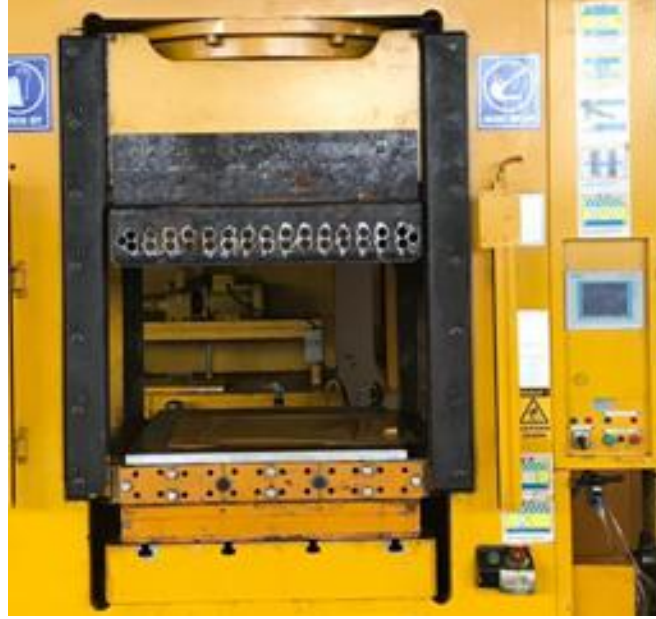
Resim 3.4 600 Tonluk hidrolik prese ait fotoğraf.
