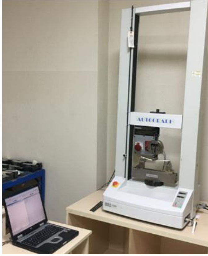
Resim 3.13 Shimadzu AGS-J 10 kN test cihazı.
