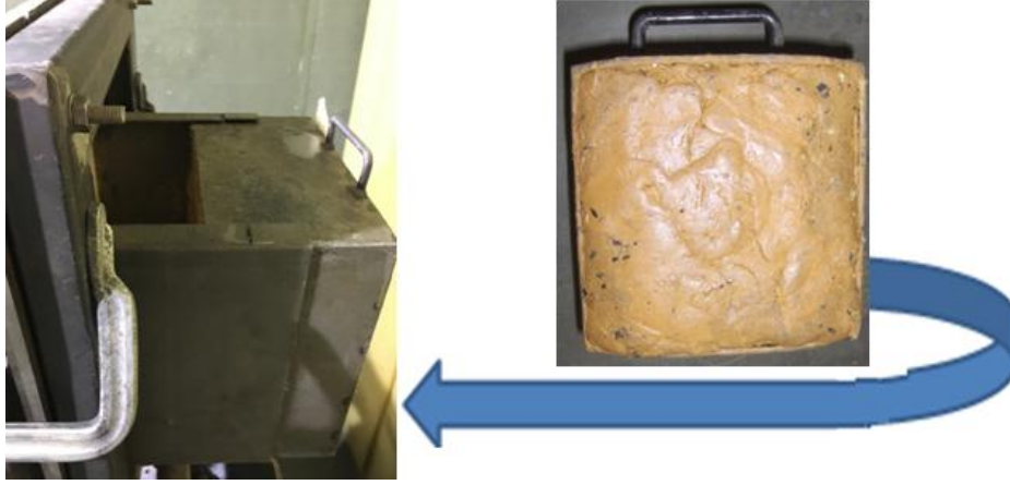
Resim 3.9 Arka kısım malzemesi ve yerleştirilmesi.
