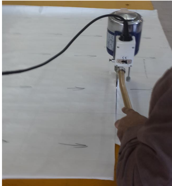
Resim 3.3 Kompozit kumař kesimi.
