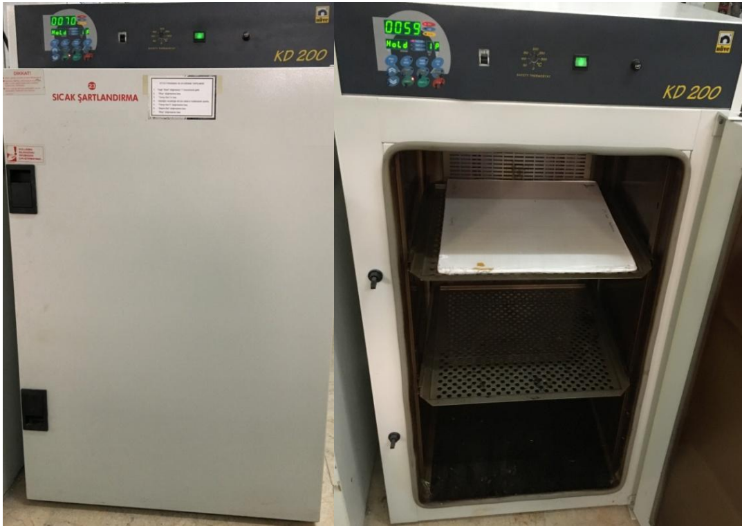
Resim 3.7 Şartlandırmanın yapılacağı fırına ait fotoğraf.
