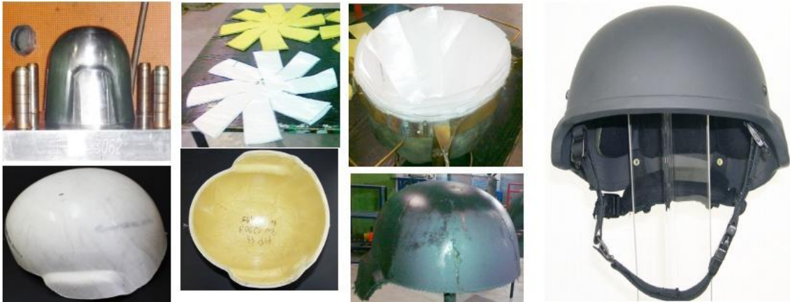
Resim 1.2. Balistik hibrit kask üretiminin adımlarını gösteren fotoğraf (Fejdys vd. 2015).
