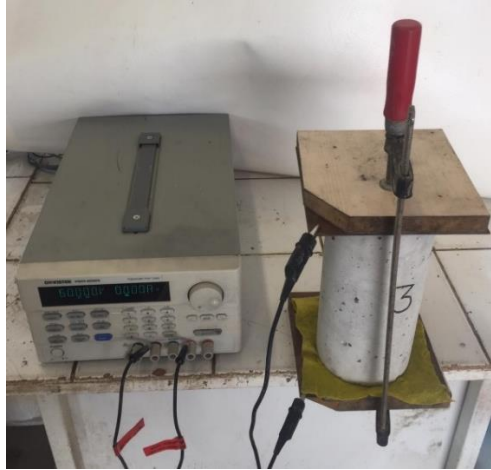
Resim 3.6 Elektriksel özdirenç deney düzeneği.
