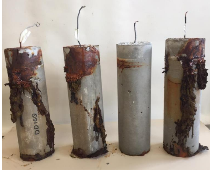
Resim 4.1 Korozyon nedeniyle hasar oluşan numuneler
