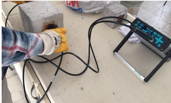
Resim 3.2 Ultrases geçiş süresi deneyinin yapılışı.
