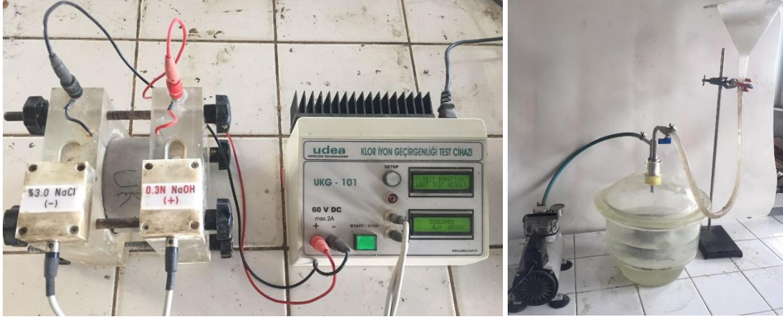
Resim 3.5 Vakumlama işlemi ve hızlı klorür geçirimsizliği deney düzeneği.
