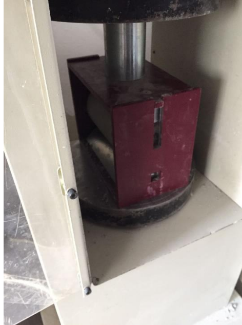
Resim 3.4 Yarmada-çekme dayanımı deneyinin yapılışı.
