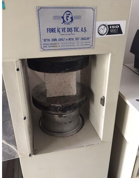
Resim 3.3 Basınç dayanımı deneyine ait görüntü.
