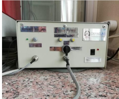
Resim 3.7 Elektroęirme cihazı toplayıcı kontrol paneli.
