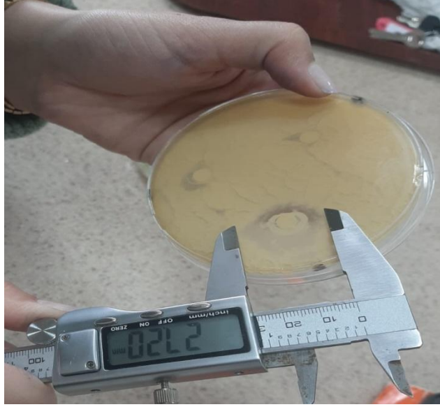
Resim 3.24 Zone çaplarının kumpas ile ölçülmesi.
