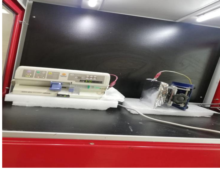
Resim 3.13 Nanolif üretimi için kurulan elektroęirme düzenegi.
