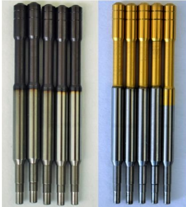
Şekil 2. TİN ve ALTİN kaplanmış gövde mili
