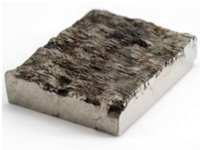
Şekil 2.18 Politecnico di Milano Polilapp Korozyon Müzesi'nde bulunan taneler arası korozyon vaka çalışması.
