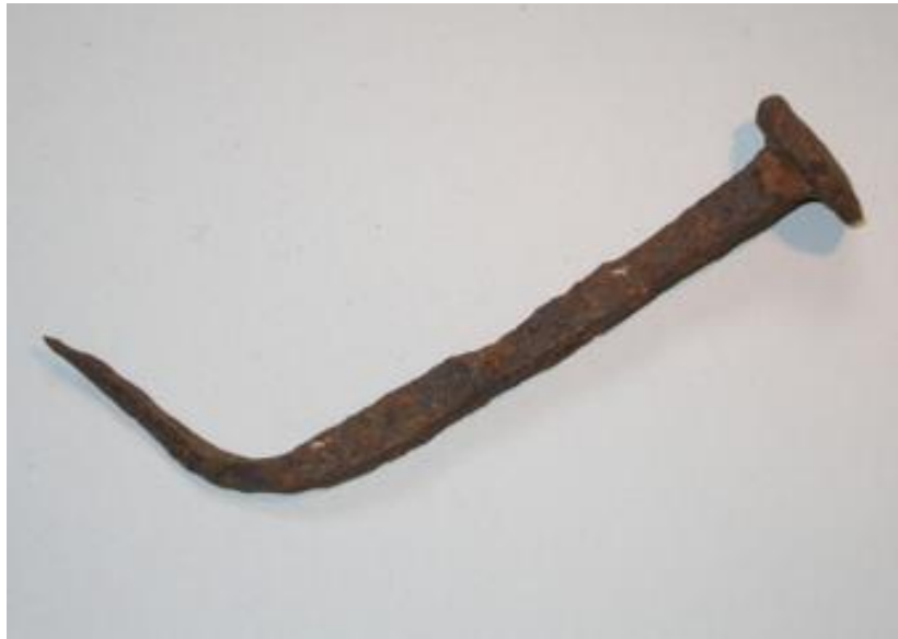
Resim 2.2 Ahşap bir kiriş içinde 150 yıl kalan bir karbon çelik çivinin yerel korozyonu. Kirişin dışındaki kavisli bölge daha belirgin bir incelme yaşamıştır.
