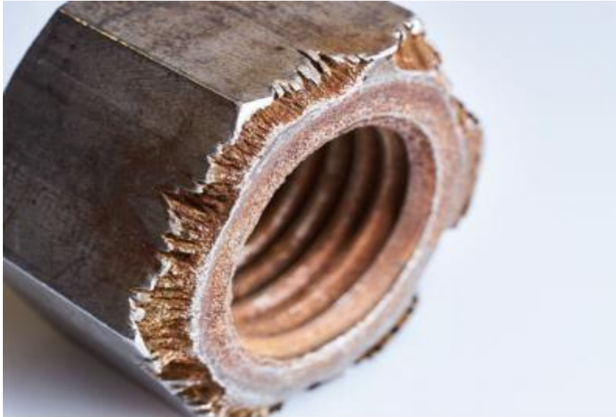
Resim 2.3 Politecnico di Milano Polilapp Korozyon Müzesi'nde bulunan çatlak korozyonu vaka çalışması.
