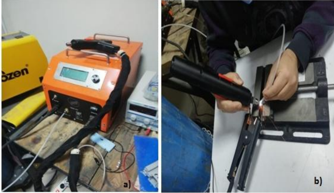
Resim 3.1 a) Elektro-kıvılcım biriktirme (ESD) cihazı, b) deneyin yapılışı.
