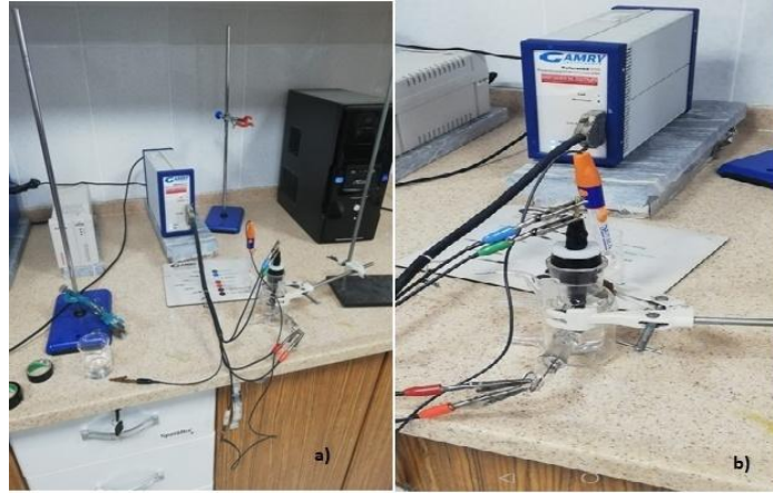
Resim 3.10 Elektrokimyasal korozyon a) Deney düzeneği, b) Deney hücresi.
