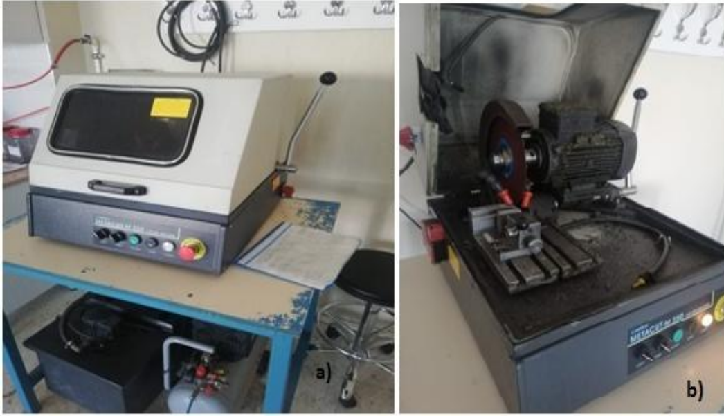
Resim 3.4 Numune Kesme Cihazının a) dış görünüşü, b) iç görünüşü.
