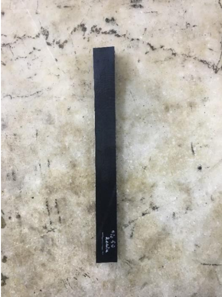
Şekil 3.13 Yapışma mukavemeti testi için hazırlanan bant numuneleri.
