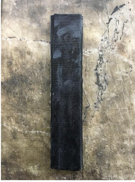
Şekil 3.9 Karkasın kaplama kauçuęu ile kaplanması.
