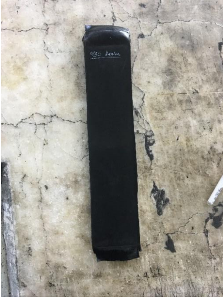
Şekil 3.12 Vulkanize olmuş bant numuneleri.
