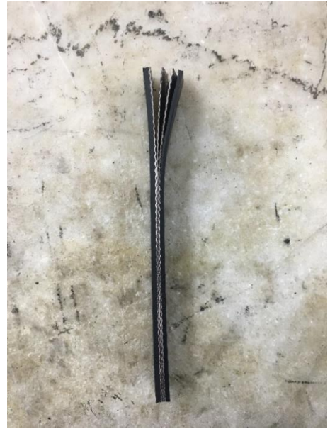
Şekil 3.13 Yapışma mukavemeti testi için hazırlanan bant numuneleri.
