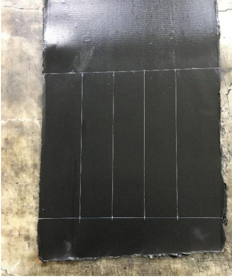
Şekil 3.7 Kauçuk hamuru ile kaplanmış kord bezinin uygun boyutlarda kesilmesi.
