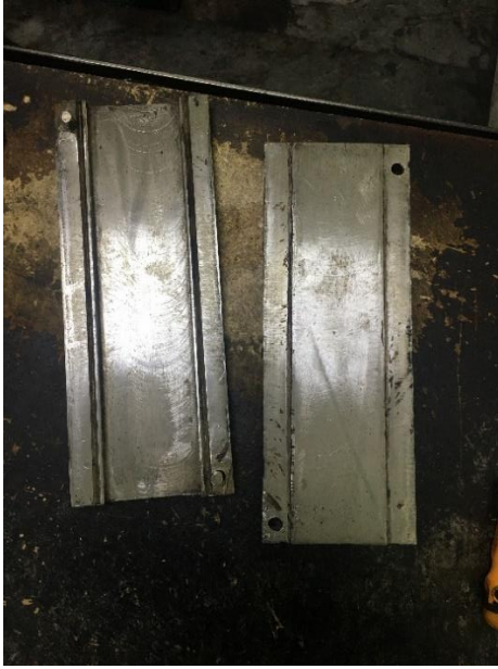
Şekil 3.11 Yapışma mukavemeti deneyi için pişirme kalıbı.
