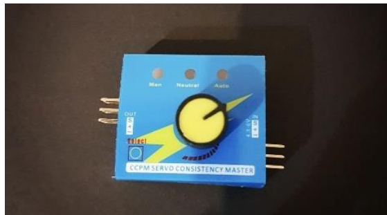
Resim 3.35 Servo motoru kontrol etmek ve kalibre etmek için değişken direnç.
